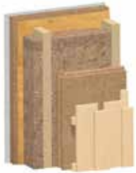
Abb. 1: Holzrahmenbauwand mit vorgehängter hinterlüfteter Fassade als Boden-Deckel-Schalung
