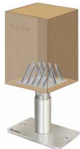
Abb. 10: Dieser Stützenfuß wird mit Vollgewindeschrauben direkt auf das Hirnholz montiert. Eine EPDM-Dichtung zwischen Kopfplatte und Stütze sorgt für zusätzlichen Schutz des Holzes vor eindringender Nässe. Bild: Eurotec
