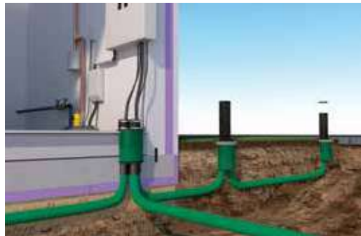
Varianten von ETGAR für Gebäude mit und ohne Keller
